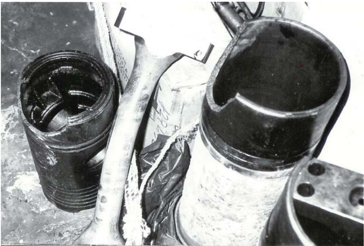
Rys.6. Pęknięcie tłoka i tulei oraz zgięcie korbowodu silnika prądnicy Fig.6. Rupture of piston and sleeve as well as bending of generator engine connecting rod
