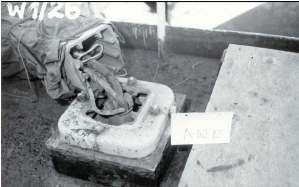
Rys.7. Złamany korpus sterownika wciągarki ładunkowej Fig.7. Broken corps of load hosting winch controller
